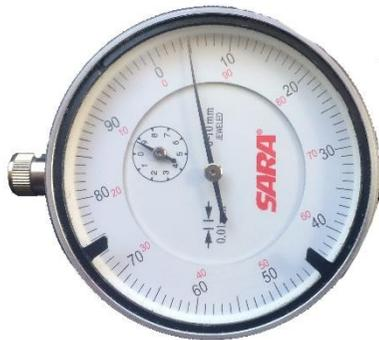
Drehen der A Achse auf die halbe Abweichung zwischen dem Wert in Handlungsschritt 9. und 0 (Beispiel 0.05mm).
