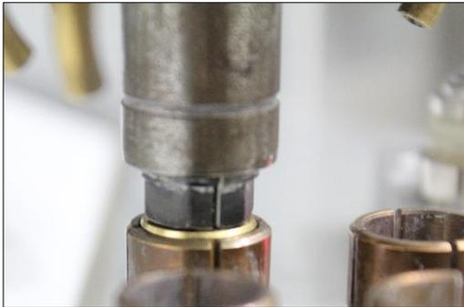
Die Spannzange muss soweit nach unten gefahren werden, bis Sie den Messingring des Schaftes berührt.
