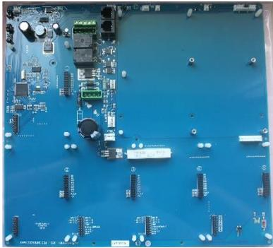
Die Endstufen und das SK Board müssen nun entfernt werden. Hierzu muss vorsichtig mit dem Daumen auf den Fixierbolzen bei gleichzeitigem anheben mit dem Zeigefinger gedrückt werden.
