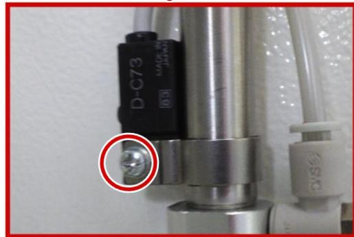
Der Sensor „Trenntür zu“ kann durch Lösen der Kreuzschlitzschraube eingestellt werden.
