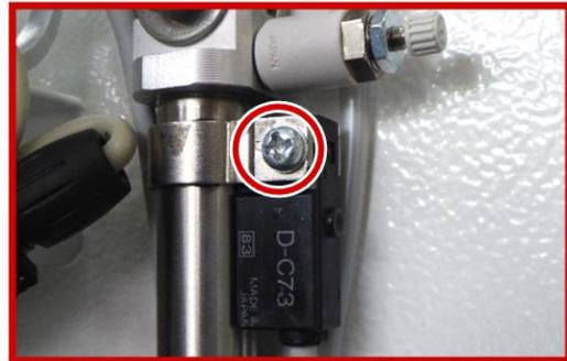
Der Sensor „Trenntür auf“ kann durch Lösen der Kreuzschlitzschraube eingestellt werden.
