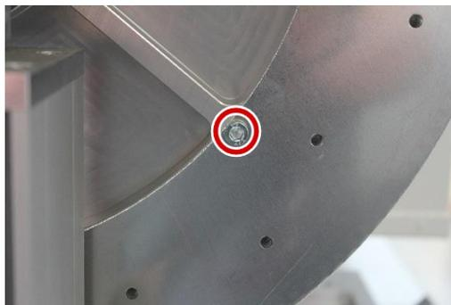
Nach Lösen der beiden M5 Zylinderkopfschrauben kann die Höhe des Positionsschalters angepasst werden. Hierbei muss der Sensor mittig zur M5 Zylinderkopfschraube am Loaderrad justiert werden.
